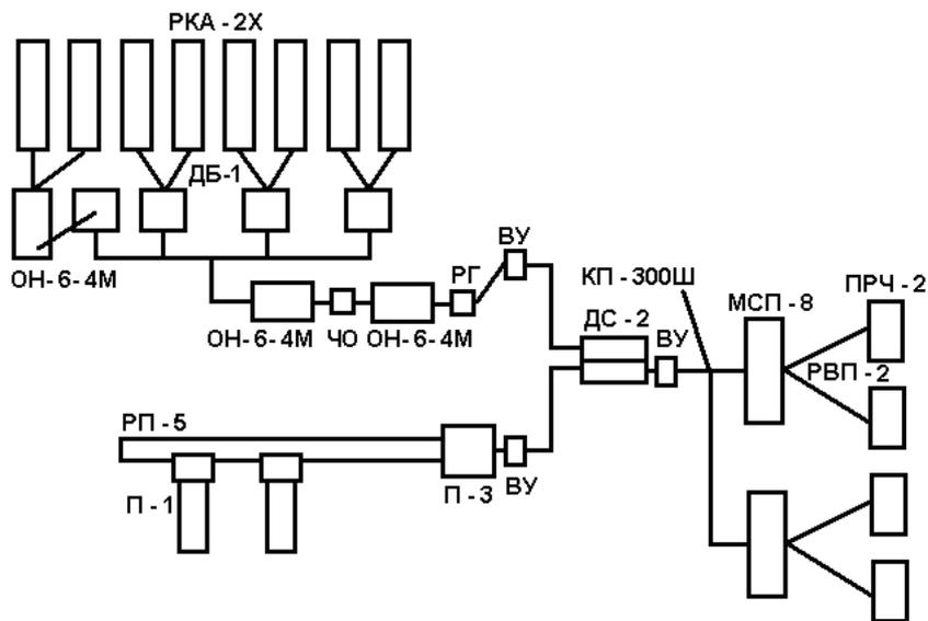
Рисунок 5 – Схема разрыхлительно-смешивающего агрегата для переработки смеси хлопкового и лавсанового волокон (до 45 %)
