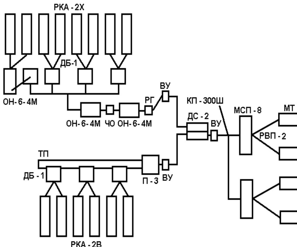
Рисунок 4 – Схема разрыхлительно-смешивающего агрегата для переработки смеси хлопкового и гидратцеллюлозных волокон (до 45 %)
