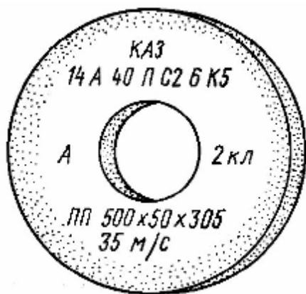
Рис. 2.1. Пример маркировки шлифовального круга
