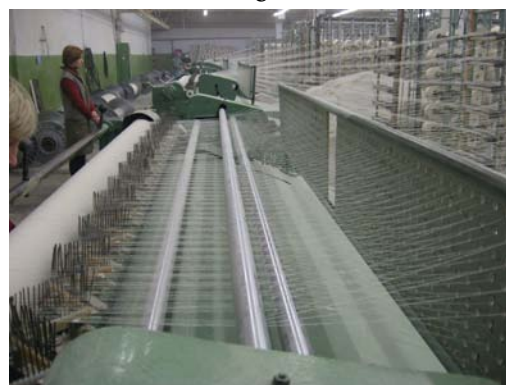
Рисунок 11 – Рабочие органы машины: а) натяжное устройство; б) глазок самоостанова нити при обрыве; в) делительный рядок; г) зубчатая гребенка
