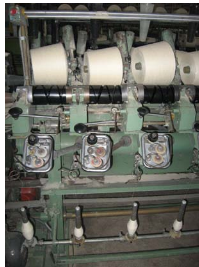
Рисунок 4 – Внешний вид: а) початки с пряжей; б) мотальная машина М-150
