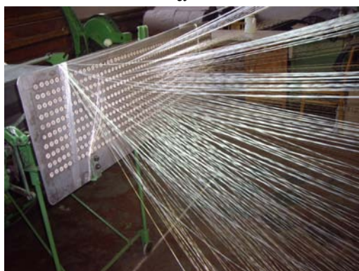
Рисунок 11 – Рабочие органы машины: а) натяжное устройство; б) глазок самоостанова нити при обрыве; в) делительный рядок; г) зубчатая гребенка
