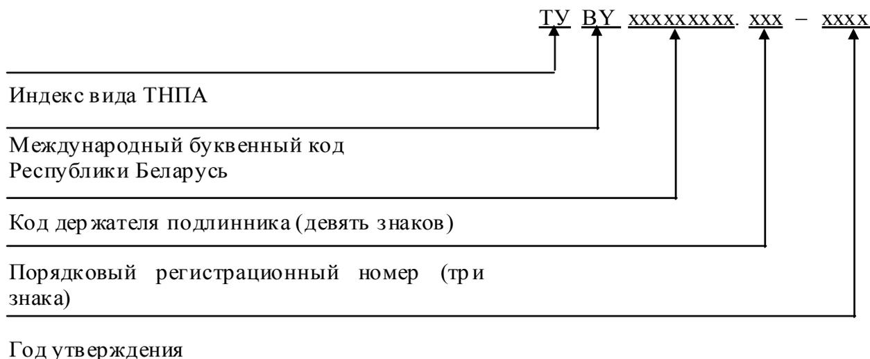
Рисунок 2.1 – Схема обозначения ТНПА
