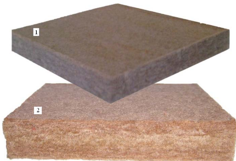
Рисунок 2.11 – Плита синтетическая мягкая (СВП-М) (сухой способ производства)
