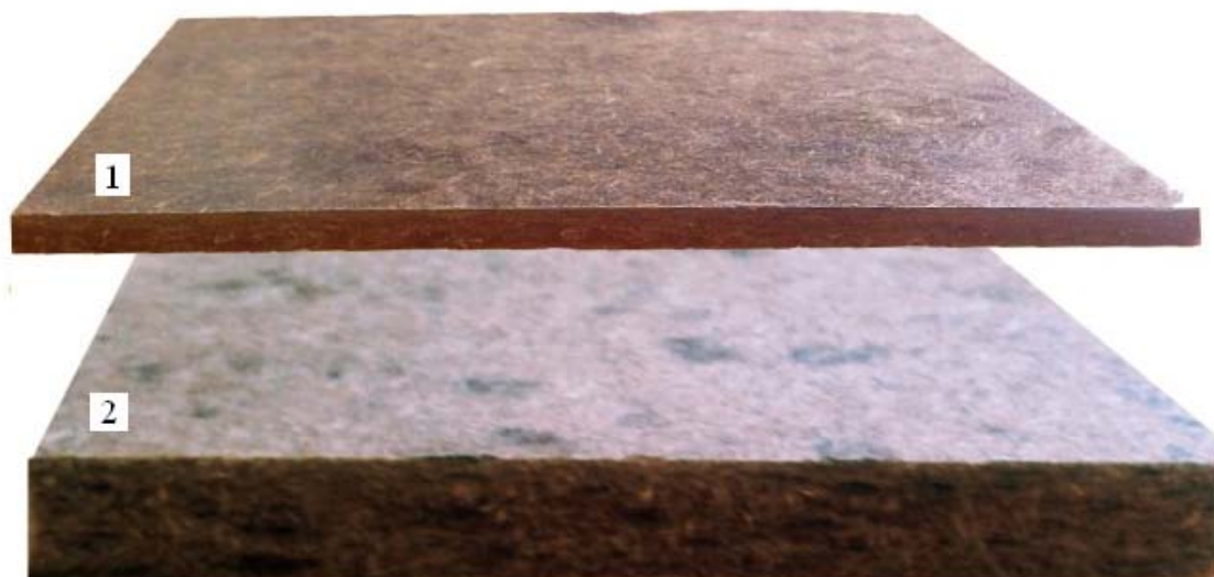
Рисунок 2.5 – Плита органо-синтетическая твердая (ОСВП) (мокрый способ производства)
