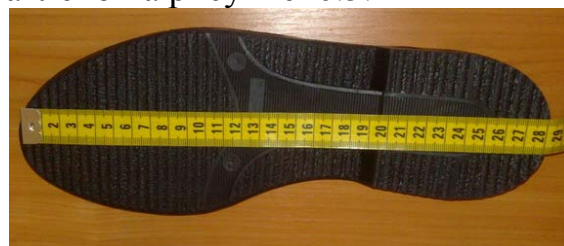
Рисунок 10.5 – Измерение длины подошвы полуботинок
