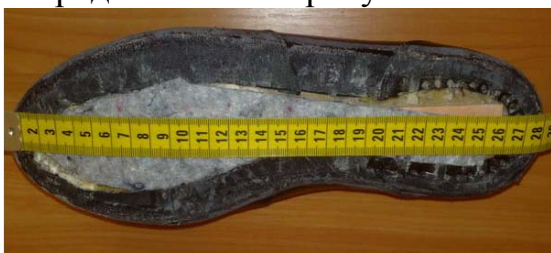
Рисунок 10.6 – Измерение длины заготовки верха полуботинок
