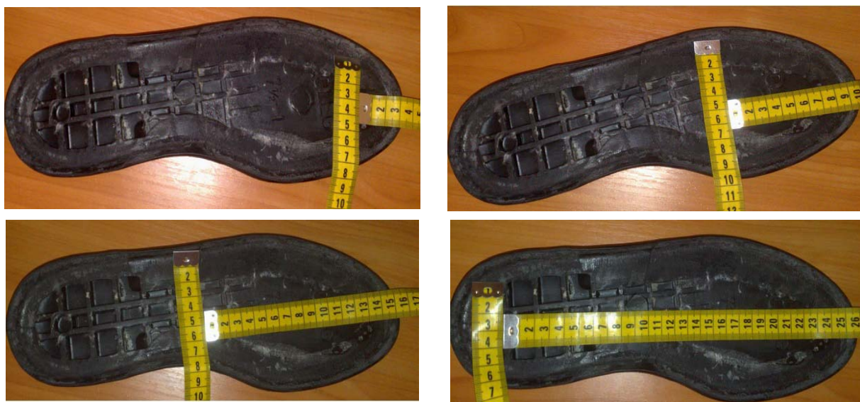
Рисунок 10.7 – Измерение ширины подошвы заготовки в четырех точках Измерение ширины заготовки верха представлено на рисунке 10.8.
