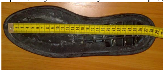
Рисунок 10.5 – Измерение длины подошвы полуботинок
