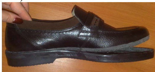
Рисунок 10.9 – Наложение заготовки верха к внутреннему следу подошвы
