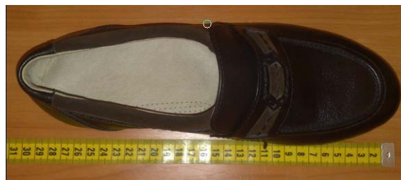
Рисунок 10.6 – Измерение длины заготовки верха полуботинок
