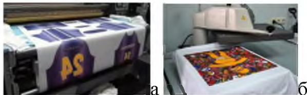
Рисунок 5 – а) печать рисунка на бумаге; б) перенос рисунка на изделие
