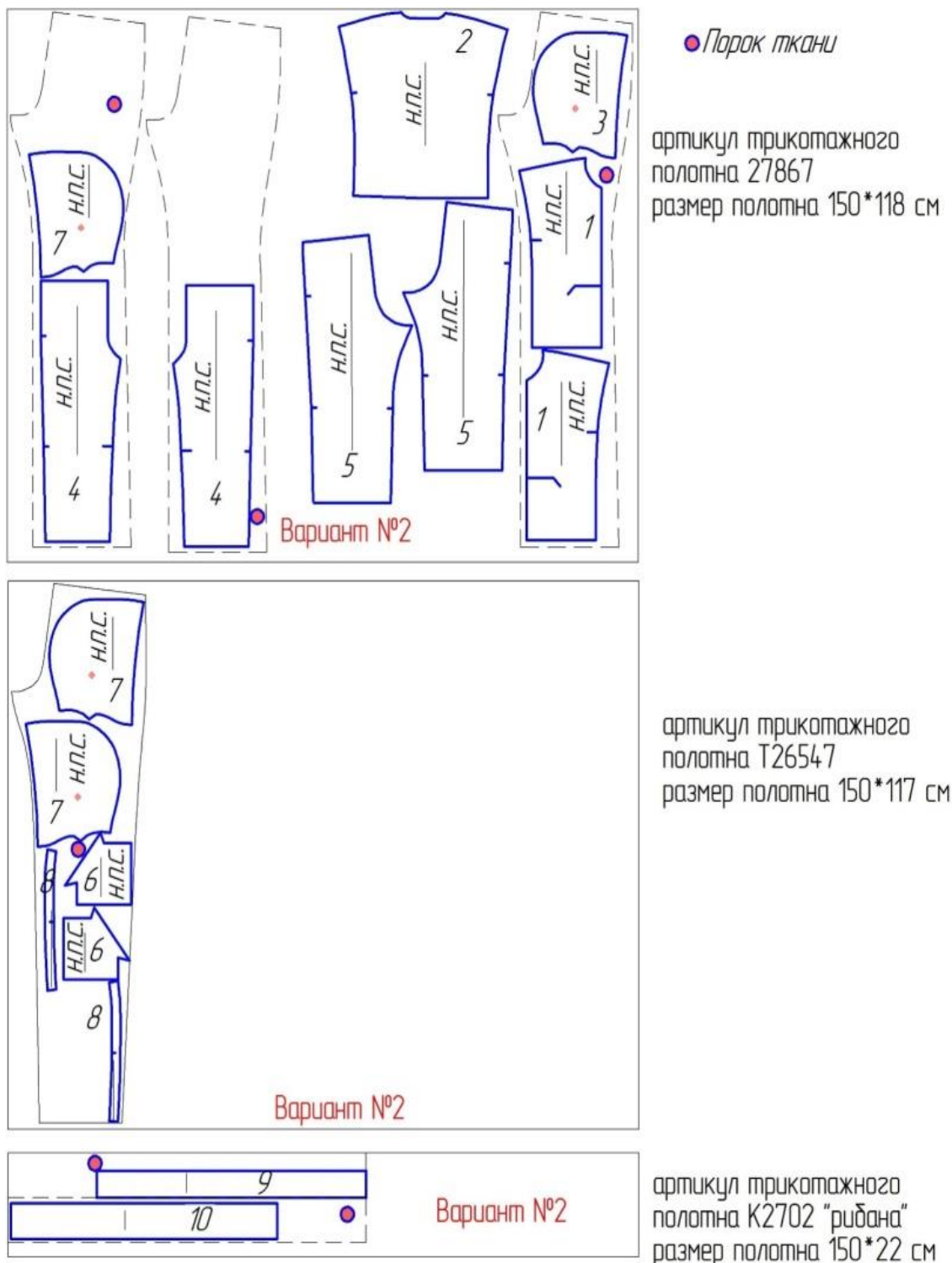
Рисунок 3. Раскладка лекал деталей кроя детского костюма (вариант 2)
