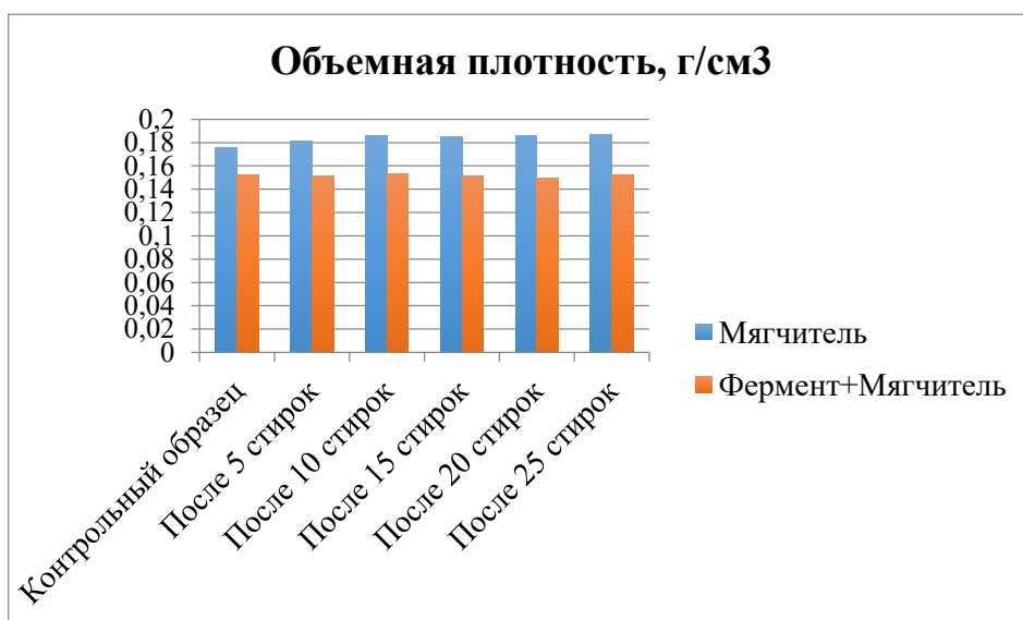
Рисунок 1 – Оценка объемной плотности махровых хлопчатобумажных изделий после цикла бытовых стирок
