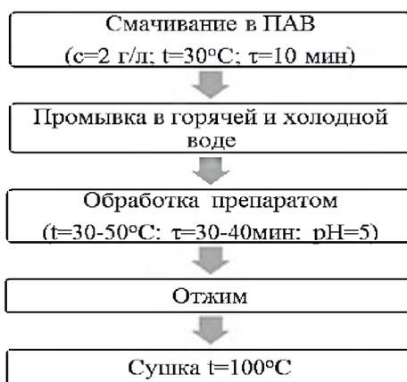
Рис. 2. Схема и режим обработки хлопчатобумажной ткани
