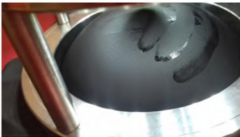
Рисунок 2 – Проникание воды без видимых капель
