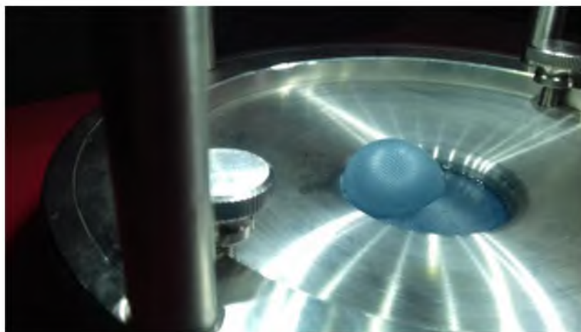
Рисунок 4 – Проникание воды в межслойное пространство структуры образца
