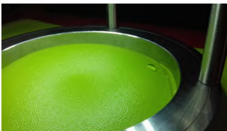
Рисунок 3 – Проникание воды через одну микротрещину у зажима
