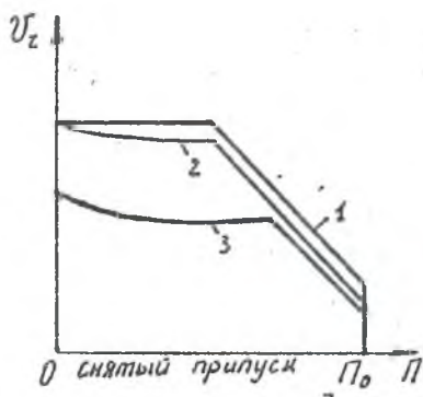
Рис. 2. Изменение формы ограничений линейной производительности при затуплении круга
