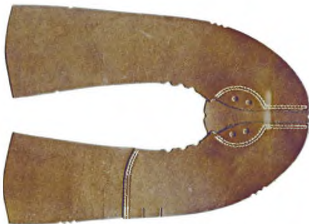
Рис. 1. Заготовка, собранная на ПШ-1
