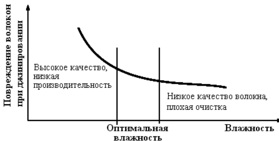
Рисунок 5 – Зависимость эффективности джинирования от влажности хлопка-сырца
