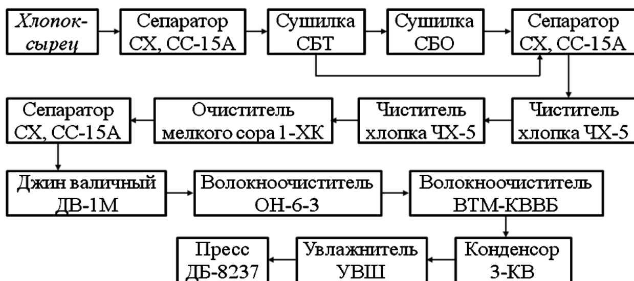
Рисунок 2 – Схема технологического процесса завода валичного волокноотделения
