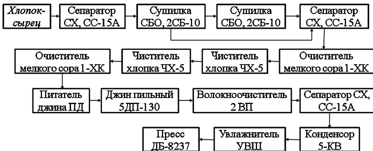
Рисунок 1 – Схема технологического процесса завода пыльного волокноотделения
